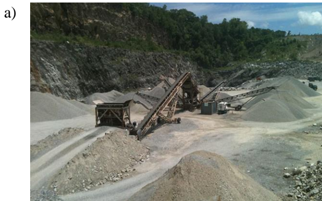
2.6 pav. Žvyro kasyba su pirminiu rūšiavimu pagal frakcijas (a)
