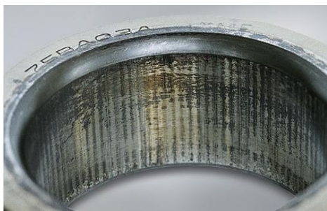
3.4 pav. Guolio vidinio žiedo fretinginė korozija
