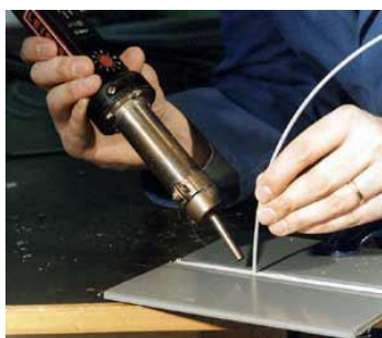
5.56 pav. Plastiko remontas naudojant karšto oro džiovintuvą ir plastikines juosteles (strypus) [11]
