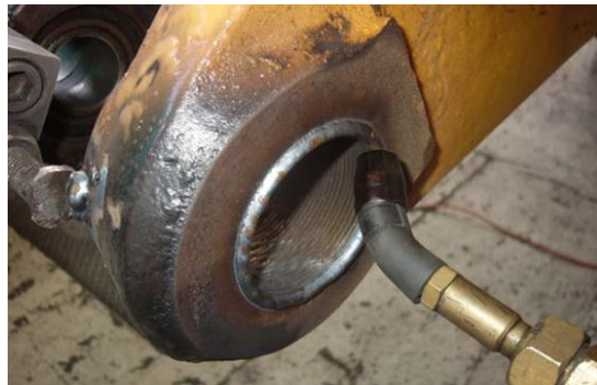
5.17 pav. Skylės paviršiaus aplydymo po fluoso sluoksniu schema: 1 – griebtuvas; 2 – aplydomoji detalė; 3 – antgalis vielai tiekti; 4 – antvamzdis flusui tiekti; 5 – bunkerio sklendė; 6 – aplydymo galvutės pagrindinis mechanizmas [1]
