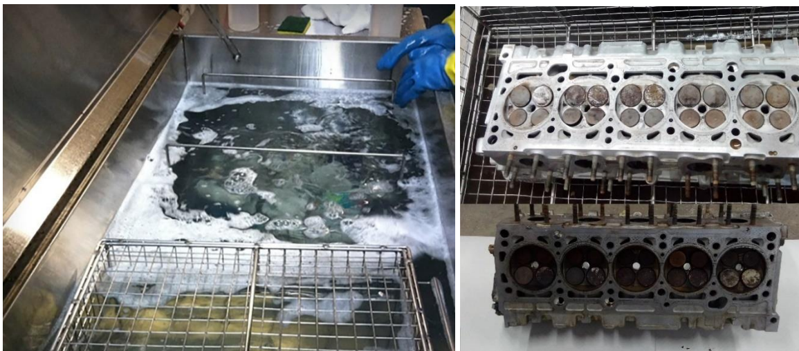
4.6 pav. Ultragarsinis valymas: a – valymo procesas [38], b – ultragarsu valyta ir nevalyta variklių bloko galva [39]
