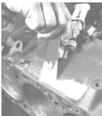
5.54 pav. Įtrūkimo variklio cilindrų bloke remontas „Metall-Set“ produktu [2]
