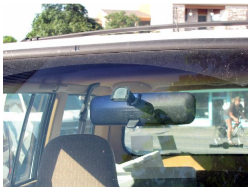
5.52 pav. Sujungimas stiklas – plastikas konstrukciniais klijais
