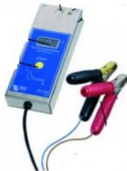
14.1 pav. Stabdžių skysčio temperatūros matuoklis DOT 300 [11]
