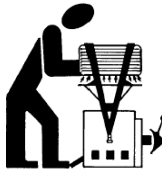
10.7 pav. Padangos tvirtinimas apsauginiais diržais pripūtimo metu
