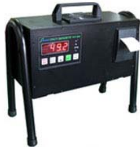
2.1 pav. Dyzelinių variklių dūmų neskaidrumo matavimo prietaisas NDO-6000 [2]
