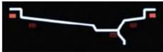
11.9 pav. Metalinių ratlankių balansavimo svarelių tvirtinimo vietos [18]
